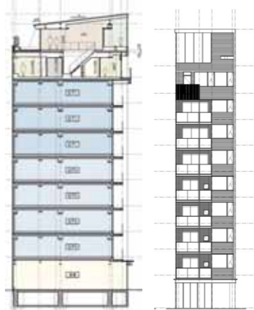
図11 共同住宅の軸組・立面
